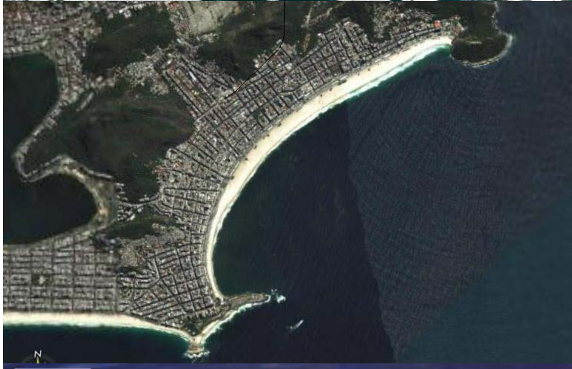
Obra flexível de alimentação artificial de areia na Praia de Copacabana (RJ) (1970)
