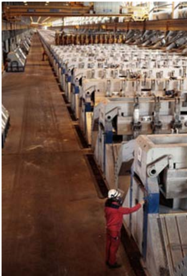
Fig. 2.24 – Sala de cubas com tecnologia Prebake – Anodos Pré-Cozidos com alimentação Central e Point Feeder - PFPB
