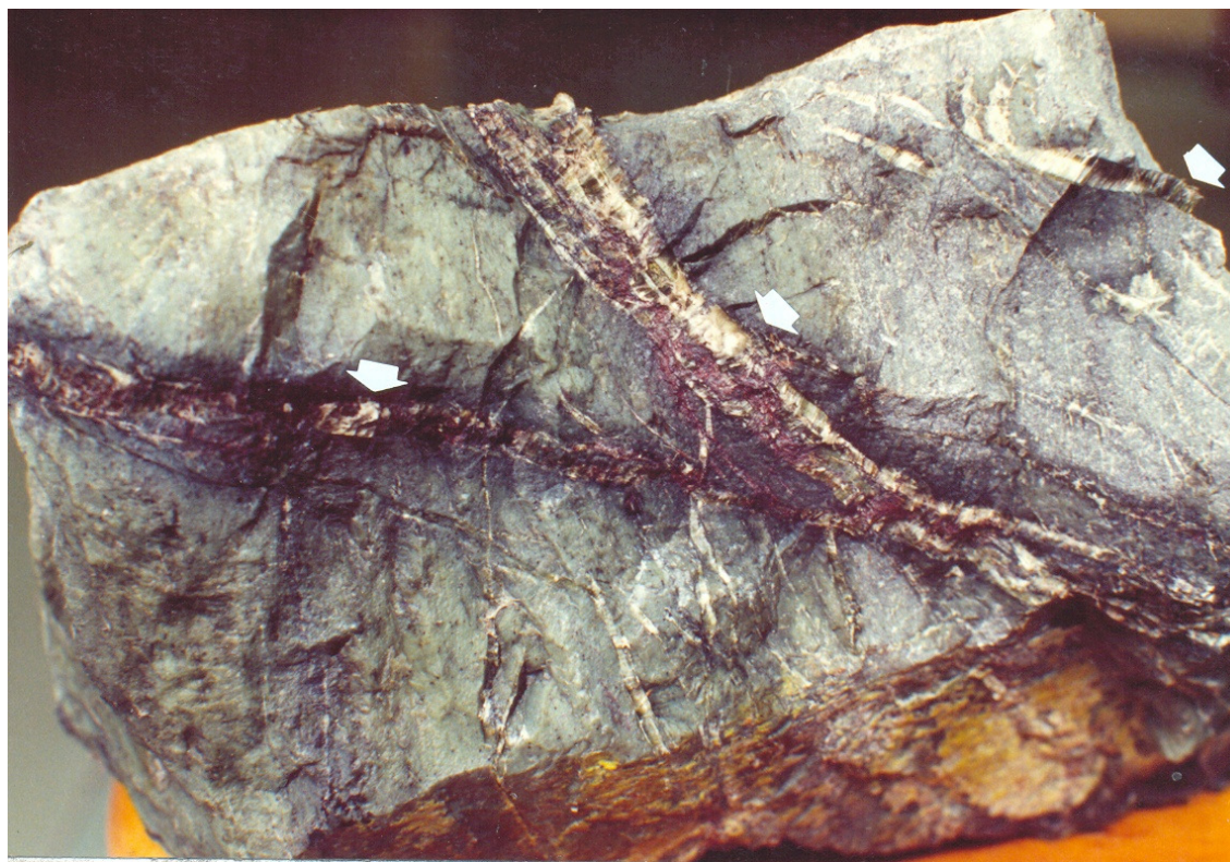
Fotografia de um fragmento de serpentinito (de antigorita) mostrando os veios contendo o amianto crisotila (setas)
