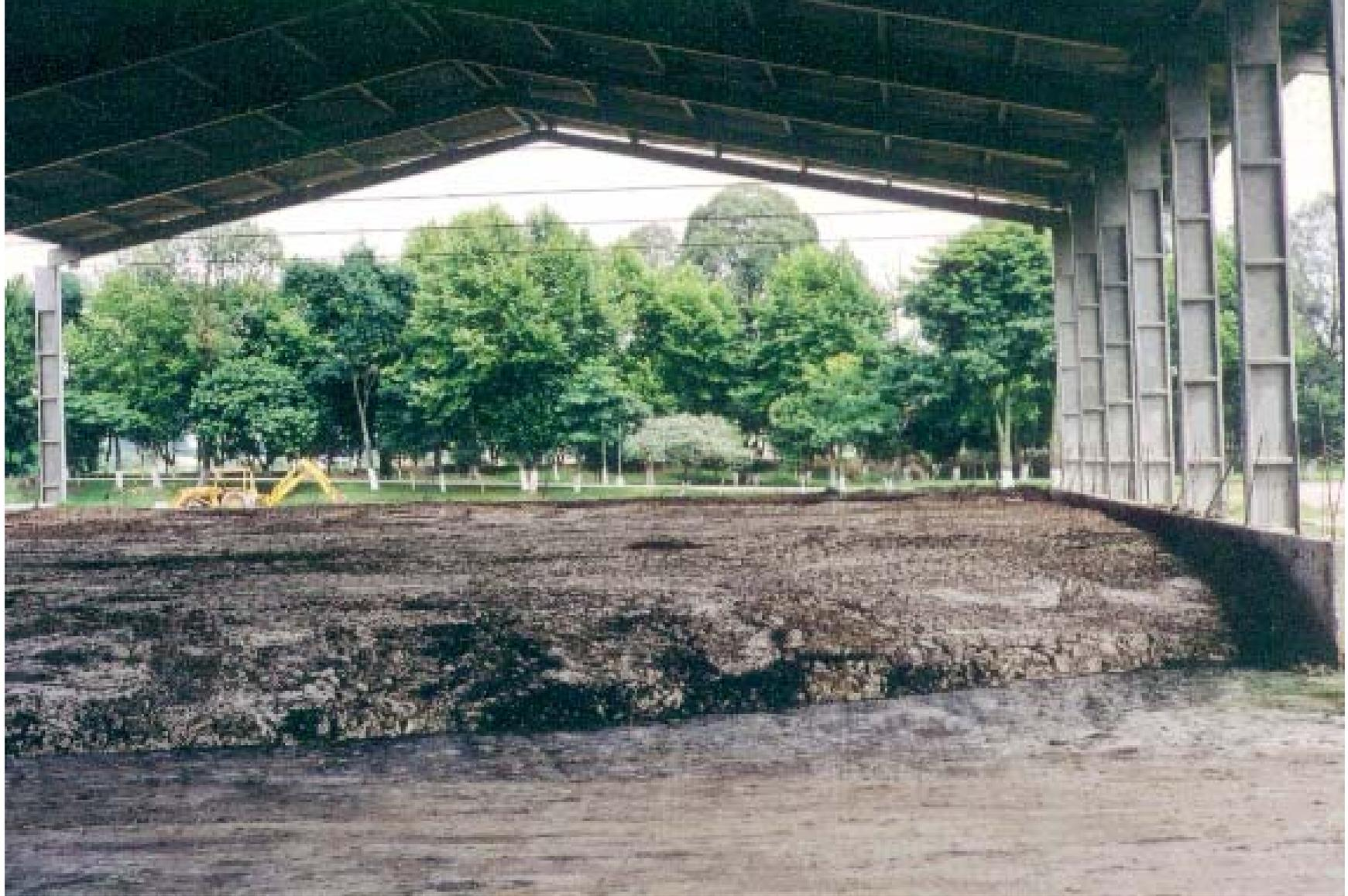
Foto 16. Lodos caleados “Classe B” apresentavam alto grau de umidade, eram semi-fluidos, não permitiam seu armazenamento em pilhas com altura maior que 0,8 m. A amostragem representativa de tal resíduo era difícil. Sanepar, ETE Belém, Curitiba. Janeiro/2003.
