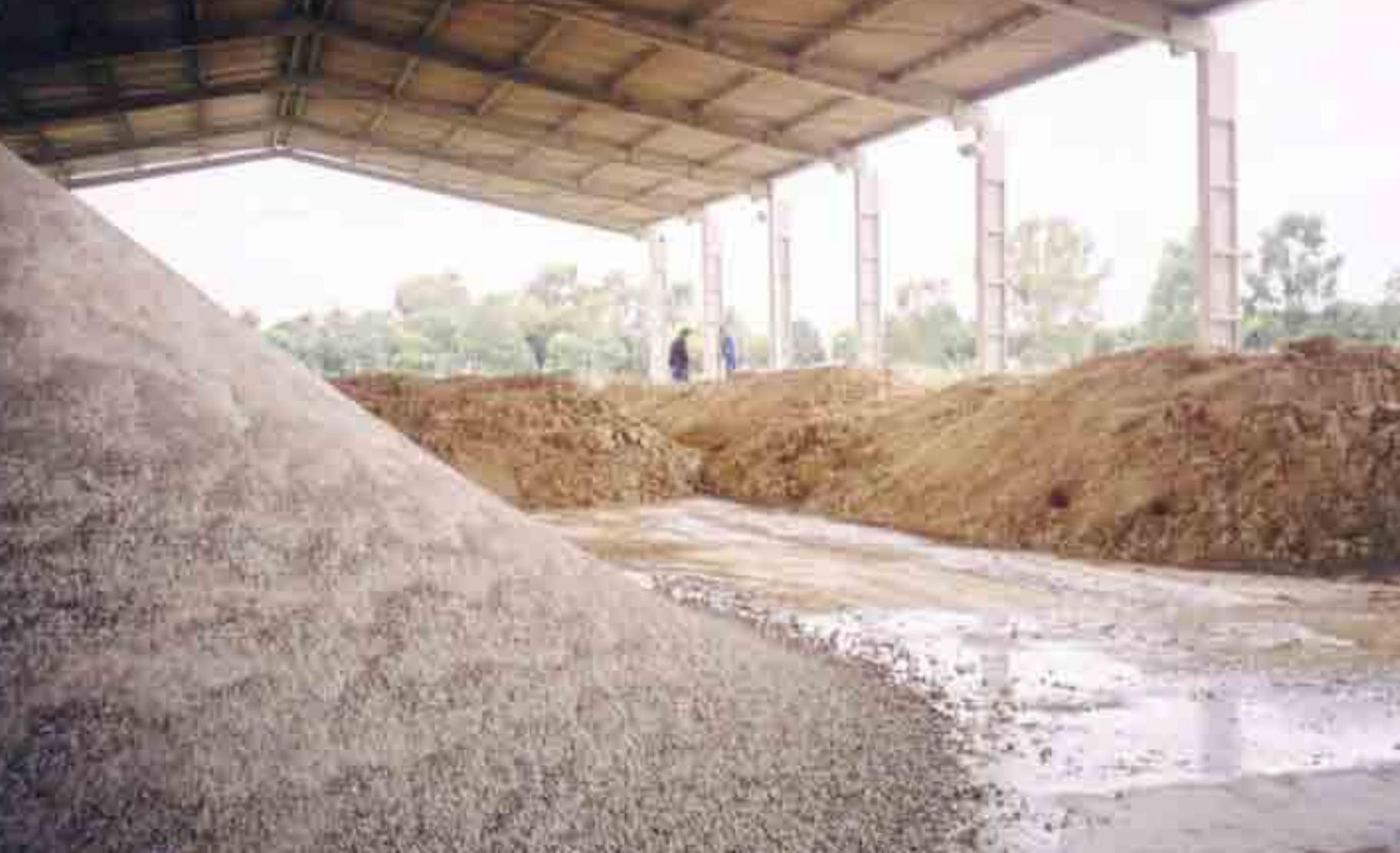
Figura 45. A amostragem dos lotes era constantemente realizada. A efetividade do Processo N-Viro já permitiria o contínuo envio dos lotes ao campo 7 dias após seu processamento em razão da comprovação operacional da redução de patógenos e da atratividade de vetores. No entanto, os laudos eram sempre aguardados. ETE Belém /Jan/04.
