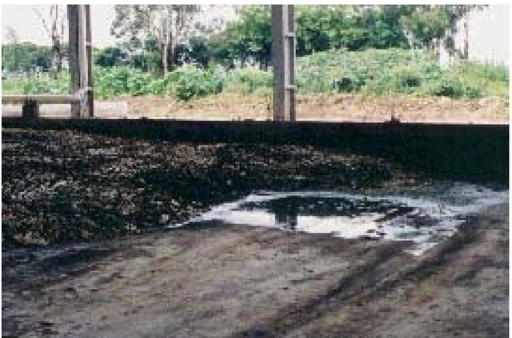
Foto 17. O lodo caleado “Classe B” produzido até o início de 2003 continuamente atraía vetores e exalava odores. O chorume produzido era um problema adicional a ser resolvido. Sanepar, ETE Belém, Curitiba. Janeiro/2003.
