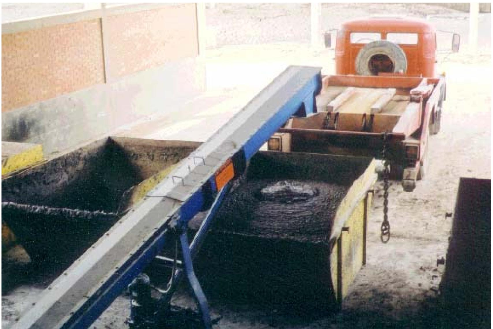
Foto 15. A Sanepar contratou empresa em 1999 (Tomada de Preços 281/1999) que se utilizou da simples adição de cal a lodos desaguados para o seu tratamento gerando “Lodos Classe B”. ETE Belém/ Curitiba PR. Novembro/2001.
