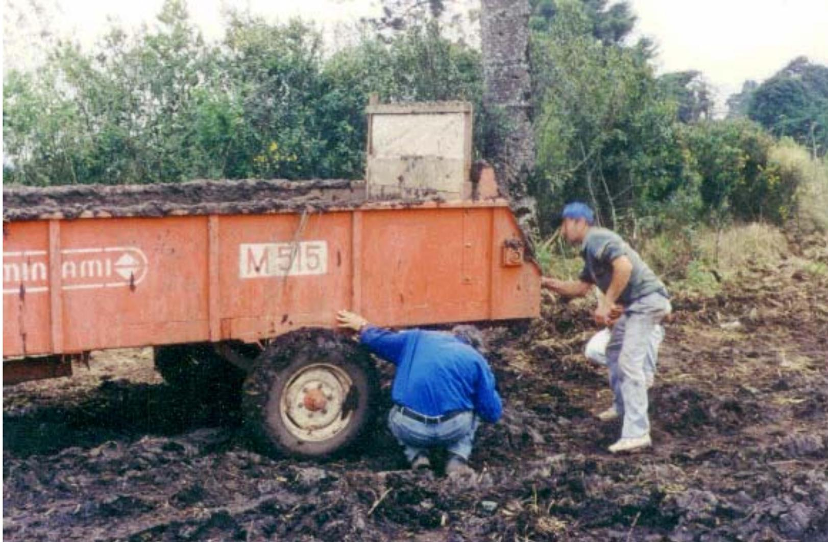
Foto 22. Em razão de sua fluidez, a aplicação dos “Lodos Classe B” era efetuada com equipamento especial disponibilizado pela Emater PR, cujo uso era previamente agendado. As condições climáticas eram um complicador adicional. Infraero, Novembro / 2002.
