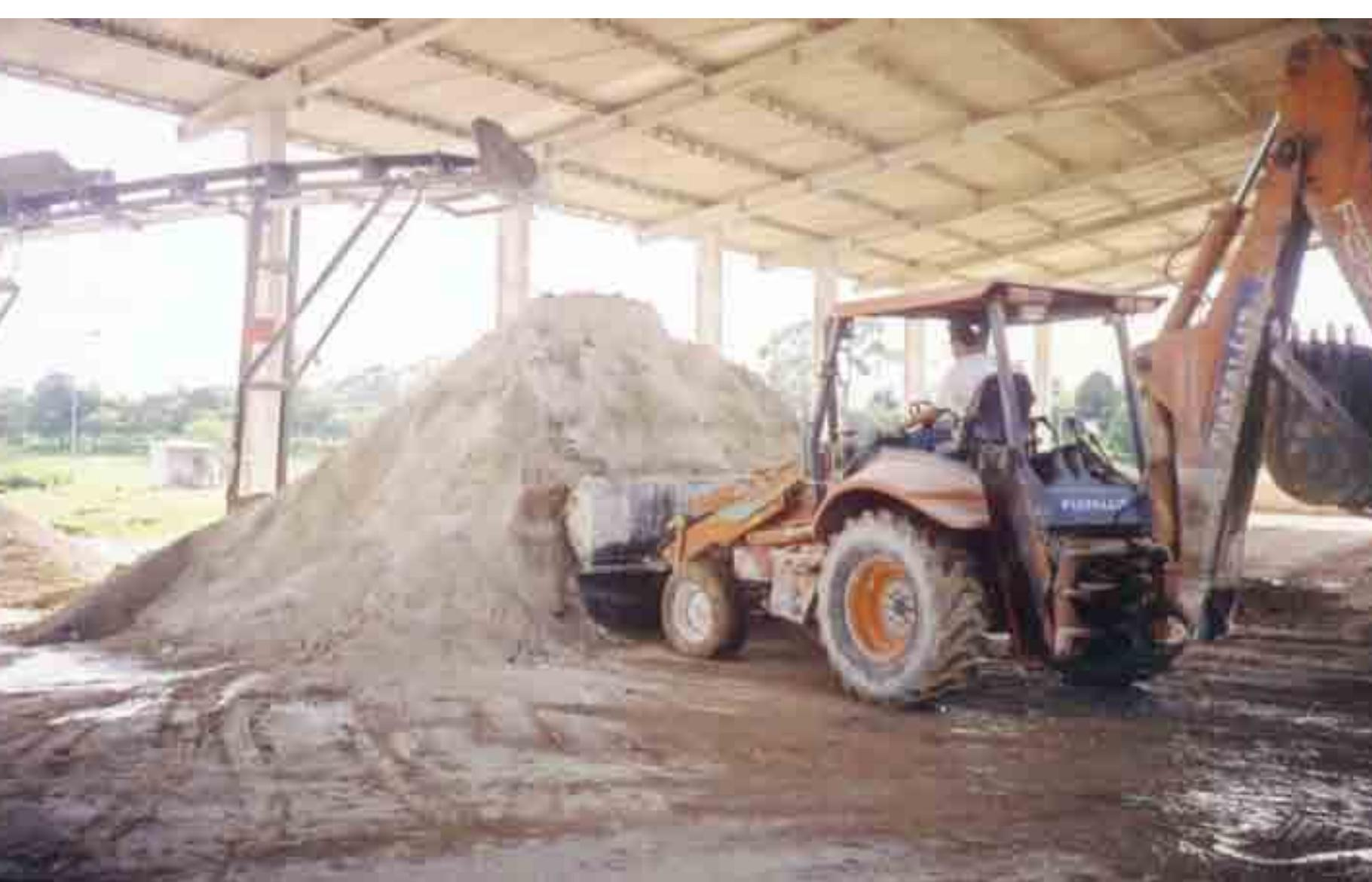
Figura 41. Após 12 horas de temperatura e pH elevados ocorria a pasteurização da massa e o material podia ser removido. Curitiba PR. (Janeiro / 2004).
