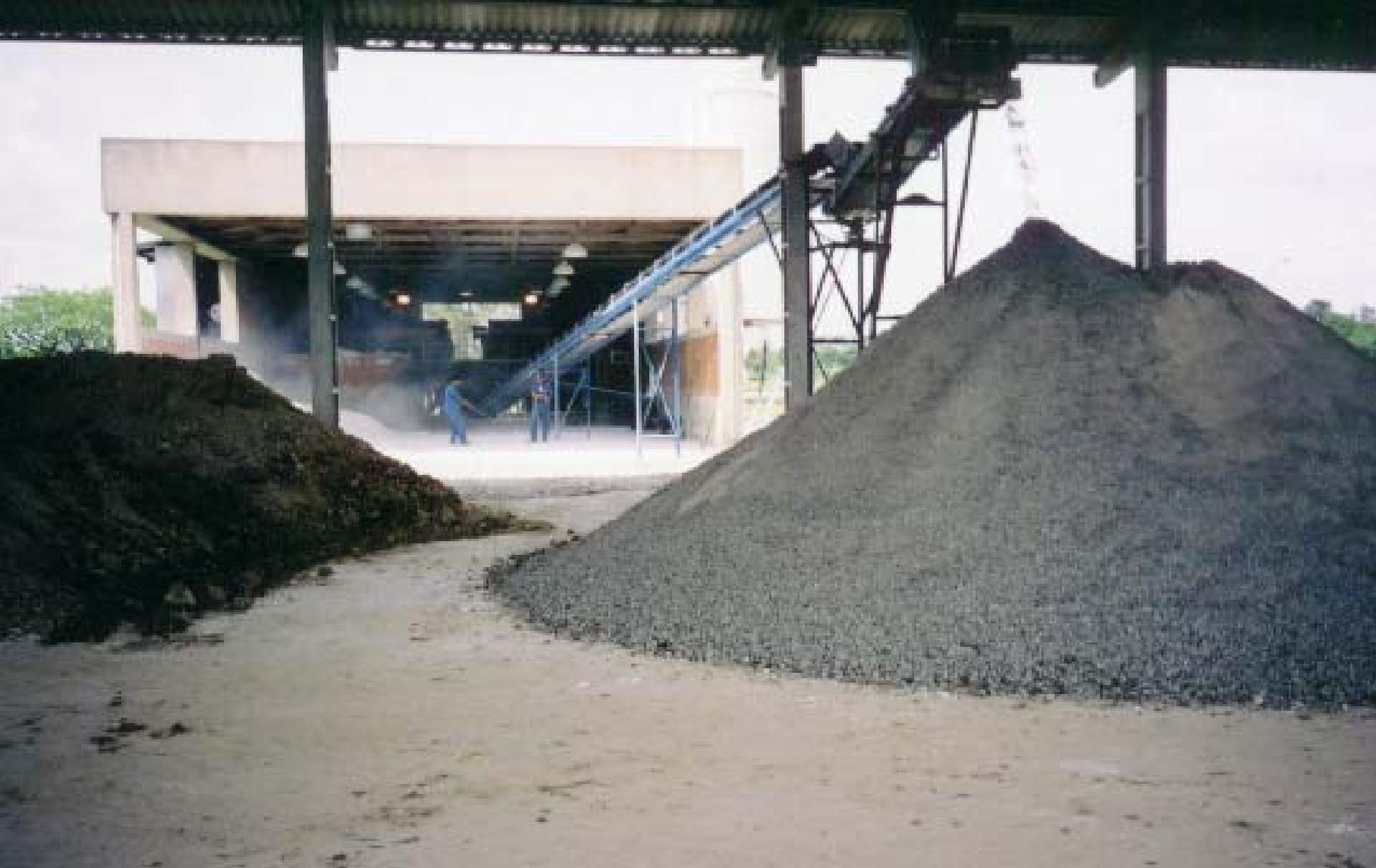
Figura 40. Conversão de lodos orgânicos em produto (N-Viro Soil) se deu na ETE-Belém da Sanepar de forma contínua até 19/Agosto/2004. Curitiba PR. (Jan/ 2004).
