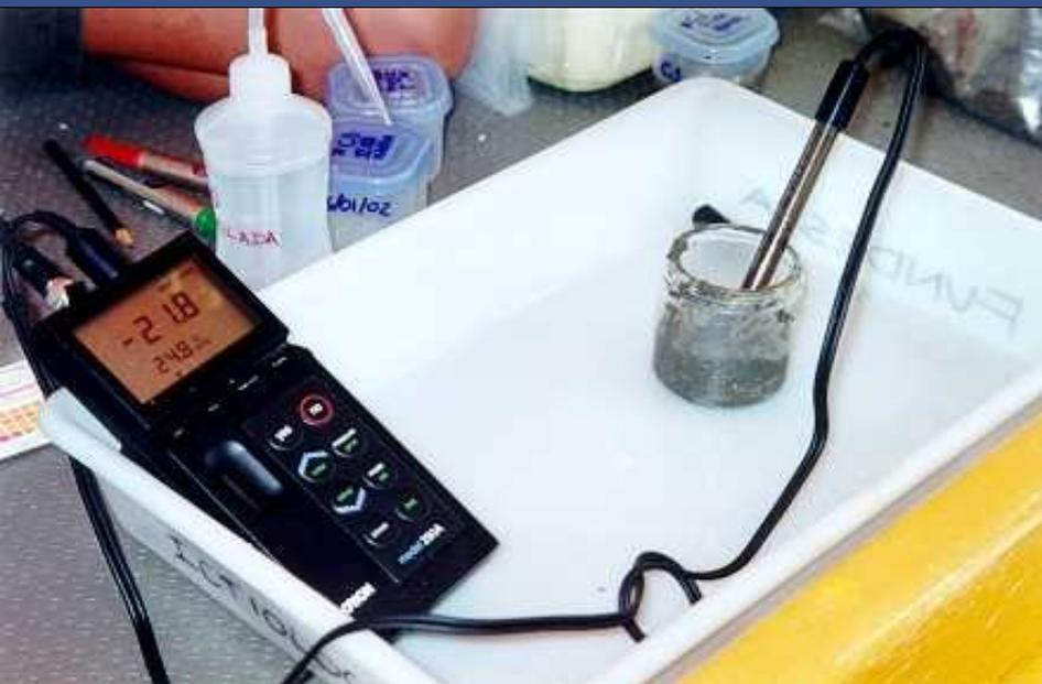
Determinação de **pH** e **Potencial Redox** "in situ" através de eletrodo de vidro acoplado a "corer sampler"
