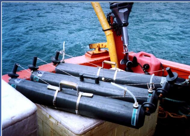
✓ Para determinação dos parâmetros **coliformes fecais, óleos e graxas, nitrato, nitrito, amônia e fósforo** as amostras são coletadas com garrafas de Niskin.
