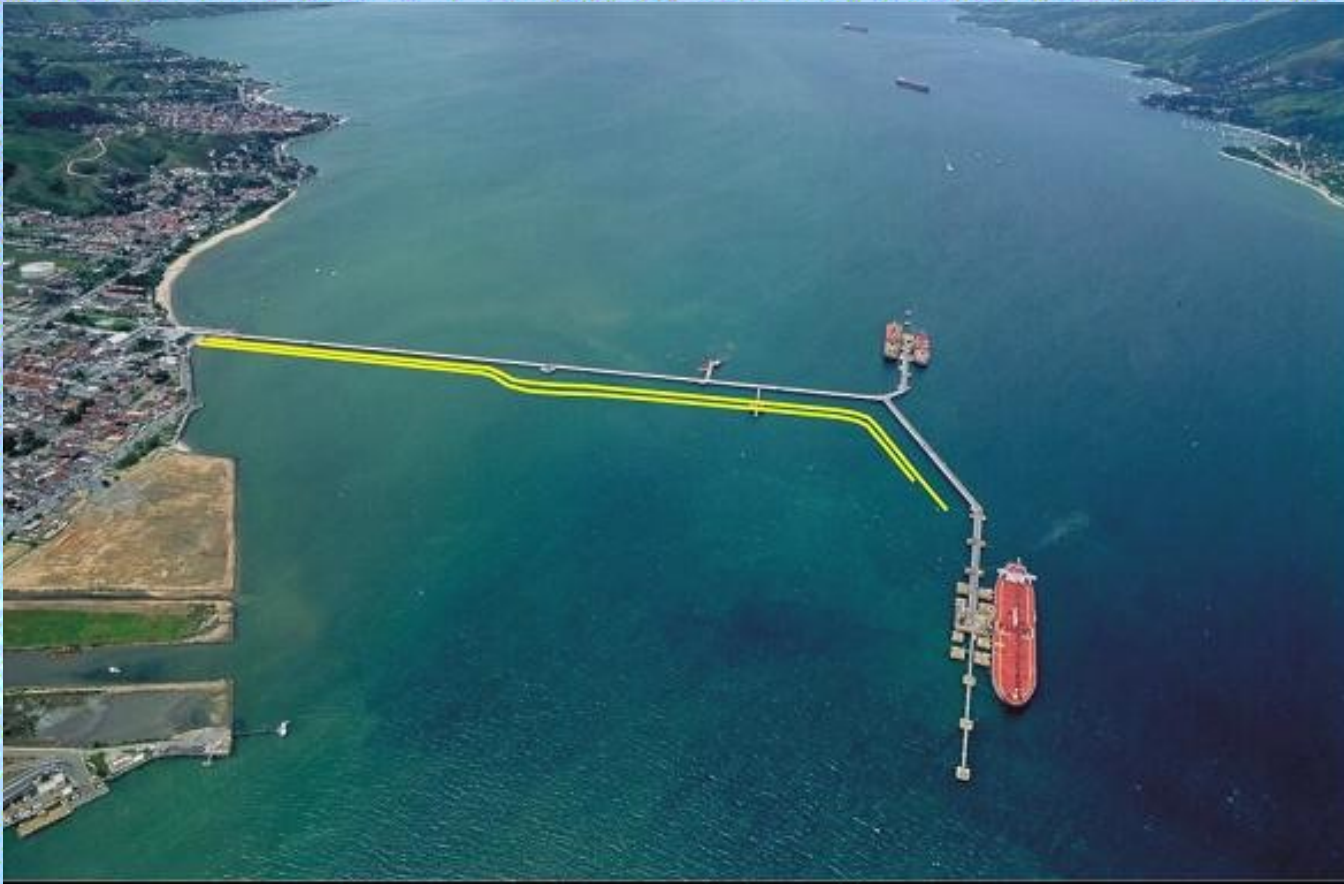
Figura: Disposição das 2 linhas do emissário submarino em relação ao piers. (FUNDESPA, 2003).
