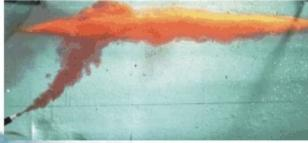
Esquema da descarga do efluente. (b)Descarga realizada com difusor constituído por múltiplas portas. (c)Descarga realizada por orifício individual
