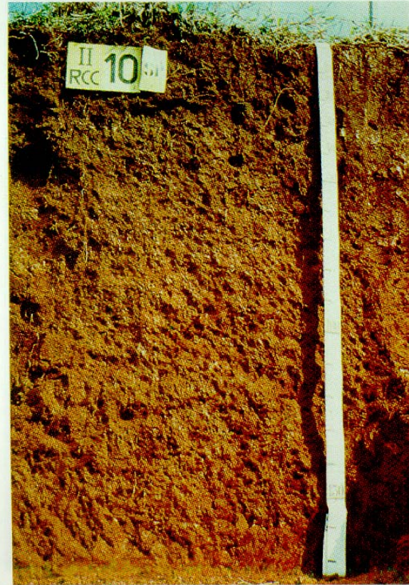
Fig.15. Perfil de NITOSSOLO HÁPLICO Eutroférico chernossólico. (São Carlos, SP)
