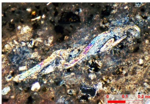
**Foto 46** - Cumeeira refeitório Coberta. Fibra de celulose. Notar abundância de pontinhos marrons avermelhados, sendo fases ferríferas hidratadas. Fibras diferenciam-se da crisotila pela forma e birrefringência. Polarizadores cruzados.
