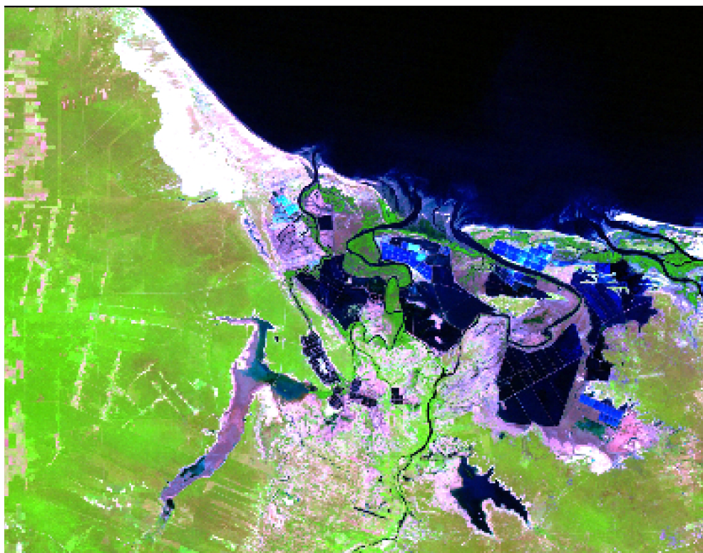
Figura 12 – Composição RGB 543 do LANDSAT 7 ETM+ de 2001, Imagem da região de Macau-RN. As zonas alagadas têm resposta espectral em tons lilás a róseo.
