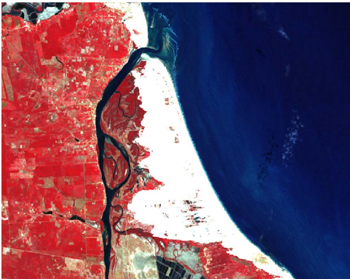
Figura 11 – Composição RGB 432 do LANDSAT 7 ETM+ (agosto de 2002), Imagem da desembocadura do rio Jaguaribe-CE. Observar áreas de manguezais em tons de vermelho escuro na margem direita do rio.
