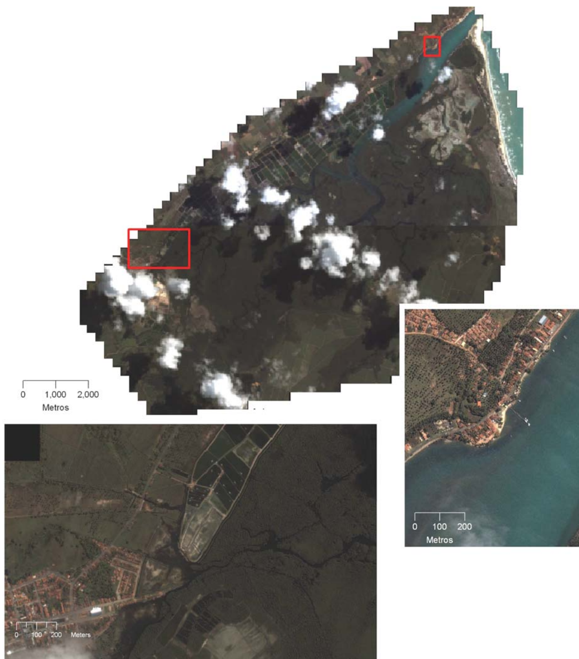
Figura 15 – Extrato de uma imagem Ikonos de composição RGB com resolução espacial de 1,0 metro. Rio Curimataú, extremo sul do Rio Grande do Norte, 2003. Detalhes da resolução deste produto onde é possível observar os aeradores nos viveiros de camarão na ampliação mais à esquerda, e o píer com duas embarcações à direita.
