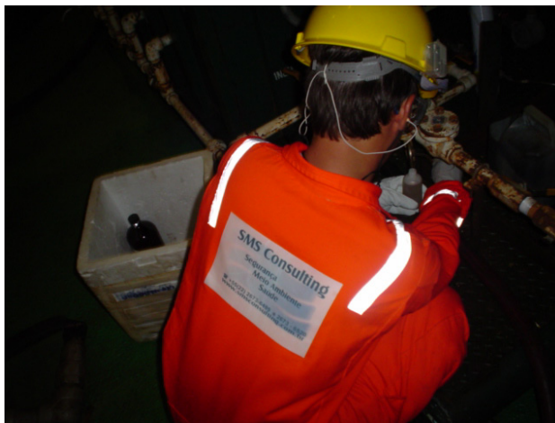
Figura 3 - Coleta de efluente após tratadores a montante do SUMP.
