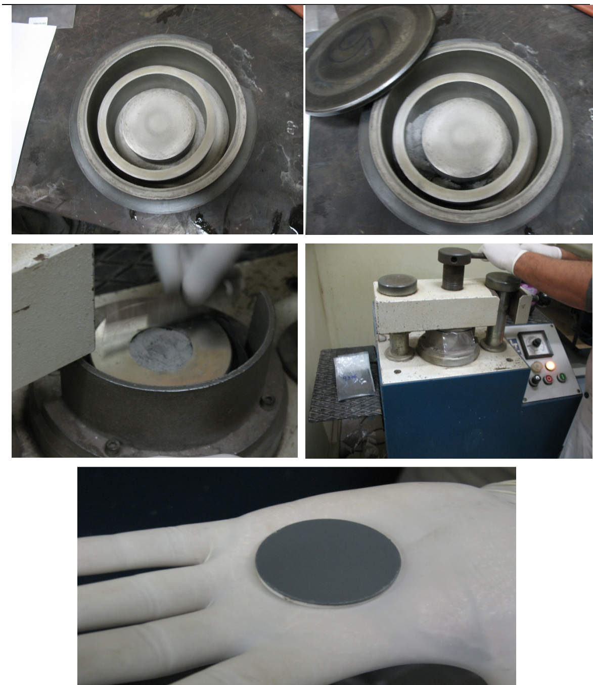
Foto 11. Procedimento de preparo de amostra para fluorescência de raios – X.
