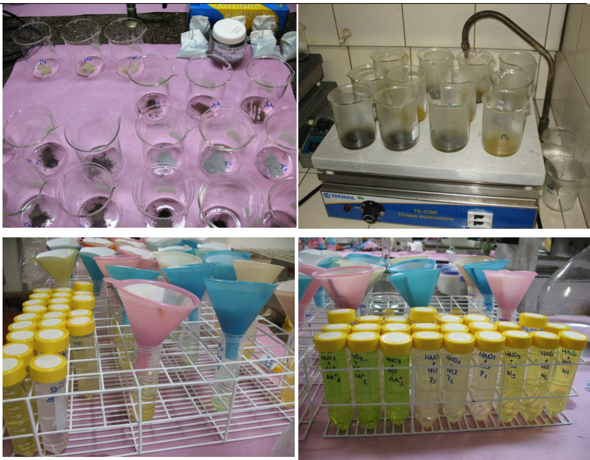
Foto 10. Seqüência utilizada na extração ácida nos fertilizantes.
