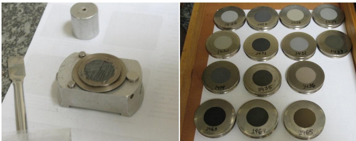
Foto 12. Procedimento de preparo de amostra para difratometria de raios – X (as amostras foram moídas conforme procedimento anterior).
