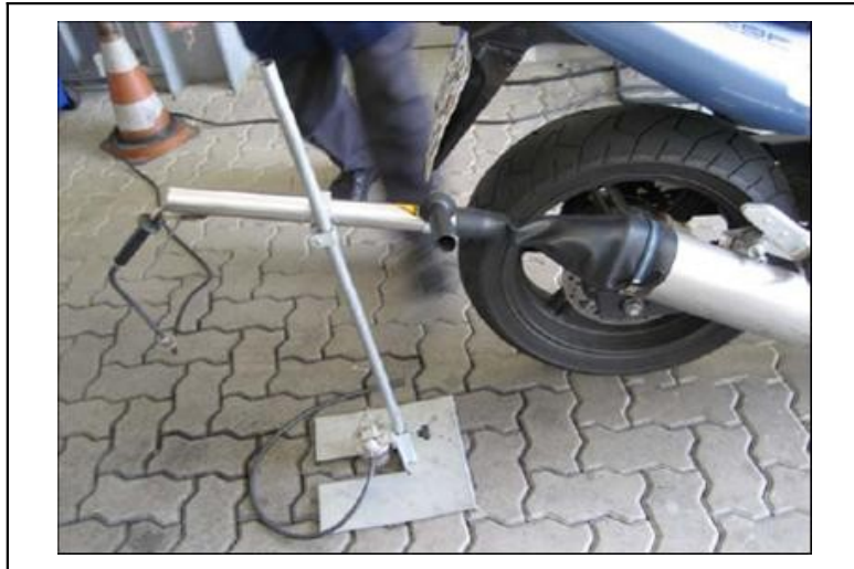
Figura 1 - Extensão com sonda móvel e coifa flexível para absorver pulsações
