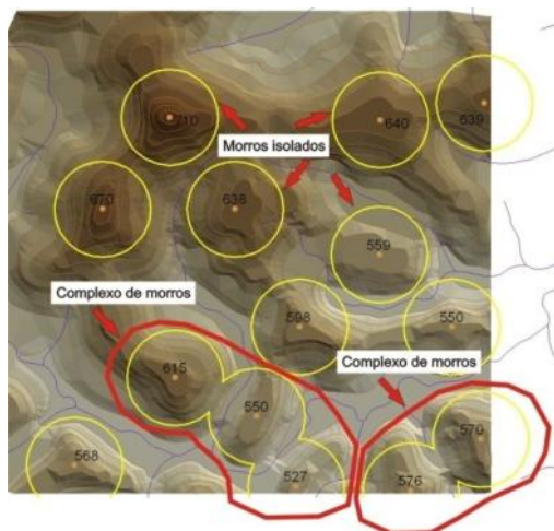
Figura 5 – Criação de buffers de 250 metros de raio, referente a cada cume, para identificação de morros isolados e complexo de morros; este último é identificado sempre que os limites dos buffers se deformarem, formando blocos de buffers .
