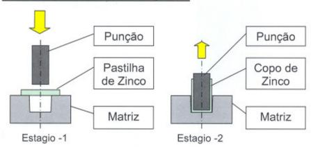
O processo de conformação plástica do metal permite a obtenção de peças no estado sólido, com características controladas, através da aplicação de esforços mecânicos em corpos metálicos iniciais que mantêm os seus volumes constantes. De uma forma resumida, o objetivo desse processo é a obtenção do produto final com especificações claras de dimensões, propriedades mecânicas e condições superficiais, conciliando qualidade e baixos custos de fabricação, mesmo com elevadas velocidades de produção.
