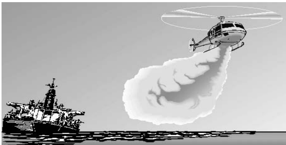
Figura 6 - Sistemas de aplicação de dispersantes adaptados para helicópteros
