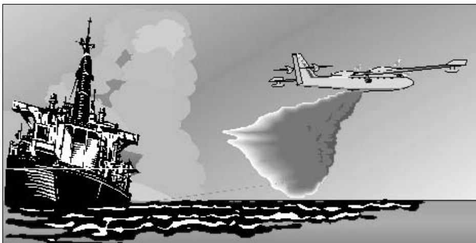
Figura 5 - Sistema de aplicação de dispersantes adaptado para aviões
