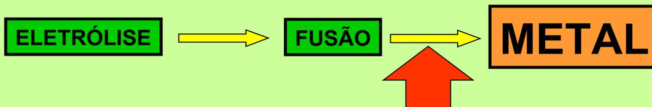
Na produção de Zinco SHG 99,99%, na última etapa produtiva, os Anodos de Zinco (Placas de metal formadas eletroliticamente) são fundidos para formatação dos lingotes, entretanto ocorre que a superfície do zinco metálico, em estado líquido, em contato com o oxigênio atmosférico propicia a oxidação do zinco (Cinzas de Zinco SHG) ocorrendo desta forma a produção involuntária do óxido de Zinco
