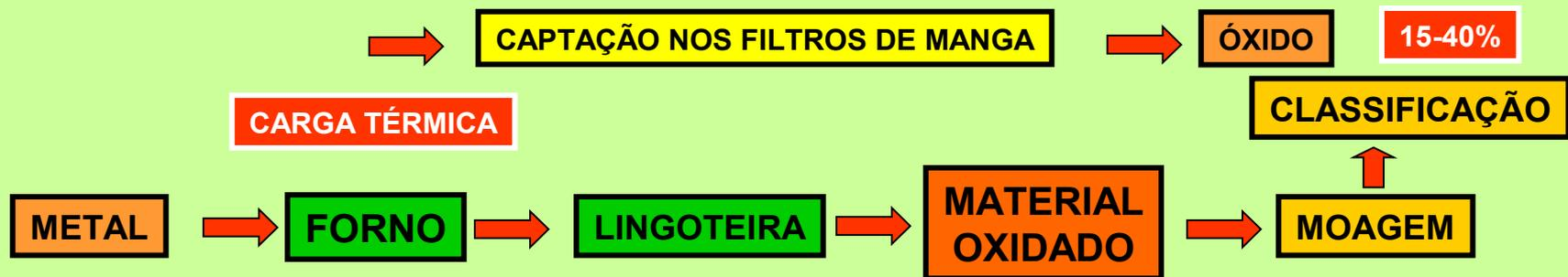
No processo de fusão do cobre secundário(sucata) feita em fornos rotativos, o metal ao atingir o estado líquido(que é drenado para a formação de lingotes) em contato com o oxigênio atmosférico, propicia a formação de oxidados de cobre, promovendo desta forma a produção involuntária de oxido de cobre. Deve ser moído e classificado. Quanto maior o número de fusões maior será a quantidade de cinzas e escórias geradas.
