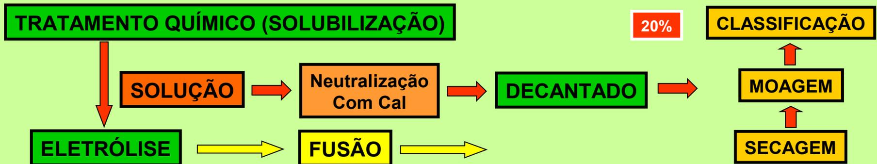
Para produção de Zinco metálico S.H.G. é preciso se obter uma solução de Sulfato de Zinco purificada para eletrólise. A carga circulante desta solução ao atingir uma determinada concentração de ferro pode gerar contaminação deste no Zinco S.H.G. Desta forma, esta solução volta para purificação ou pode ser neutralizada com Cal gerando Zinco decantado. O material deve ser seco, moído e classificado.
