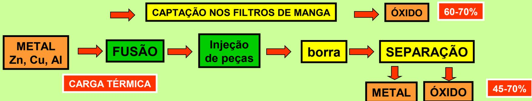
A produção de ligas “Zamak” decorre da fusão associada dos metais Zinco, Alumínio e Cobre. A produção destas ligas é feita em fornos onde através de carga térmica os metais ao atingirem o estado líquido, são drenados para a injeção de peças. Nesta operação ocorre a formação de borras, que deverão ser refundidas, e paralelamente ocorre a produção involuntária de óxido nas mangas, em função do contato dos metais em estado líquido ou gasoso, com o oxigênio atmosférico, respectivamente.
