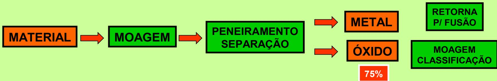
o produto resultante é moído em moinhos de bolas para desagregar a fração metálica (pingos) seguindo para peneiramento com a separação do metal que retorna para fusão e o óxido moído, classificado tem inúmeras aplicações metalúrgicas e químicas
