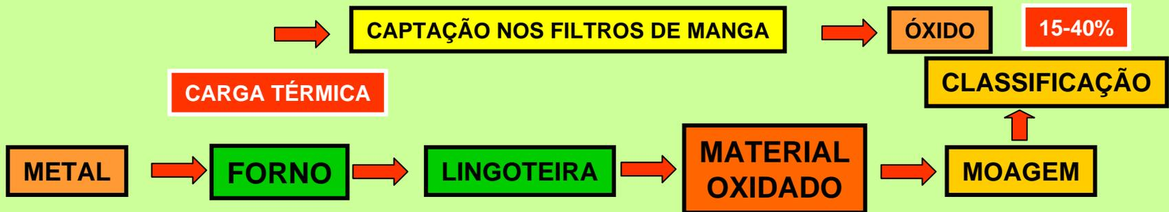
No processo de fusão do cobre secundário(sucata) feita em fornos rotativos, o metal ao atingir o estado líquido(que é drenado para a formação de lingotes) em contato com o oxigênio atmosférico, propicia a formação de oxidados de cobre, promovendo desta forma a produção involuntária de oxido de cobre. Deve ser moído e classificado. Quanto maior o número de fusões maior será a quantidade de cinzas e escórias geradas.
