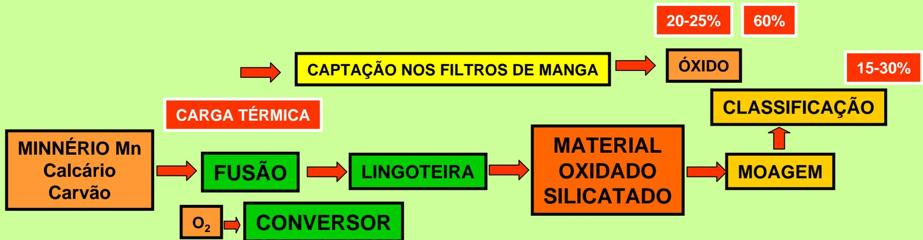
Na produção de ligas de Manganês o concentrado mineral passa por processo de fusão associado com calcário e carvão para obtenção do manganês alto carbono(forno elétrico). Nesta fase é gerado um oxidado de manganês nas mangas, bem como uma escória de manganês
