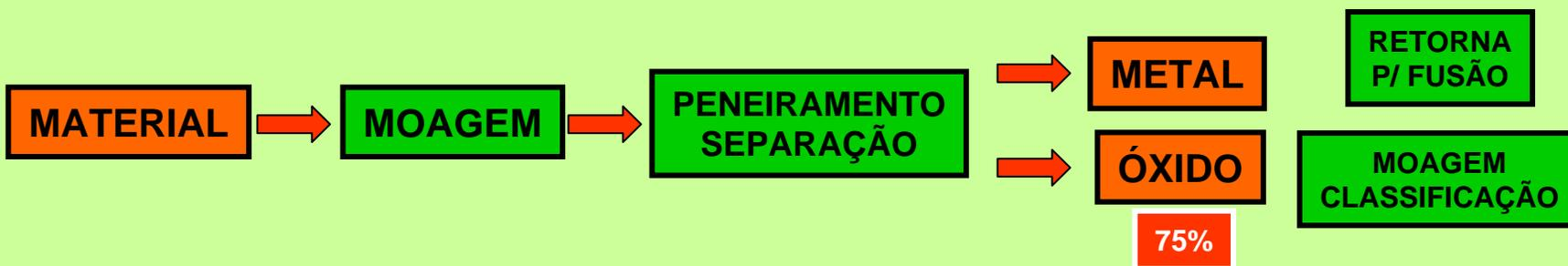
o produto resultante é moído em moinhos de bolas para desagregar a fração metálica (pingos) seguindo para peneiramento com a separação do metal que retorna para fusão e o óxido moído, classificado tem inúmeras aplicações metalúrgicas e químicas
